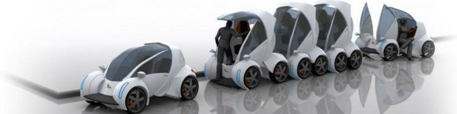
Les véhicules complètement automatisés offriront la possibilité de radicalement changer la conception des véhicules. Par exemple, la possibilité de « plier » la voiture permettrait de réduire l'emprise au sol du véhicule lors de son stationnement
