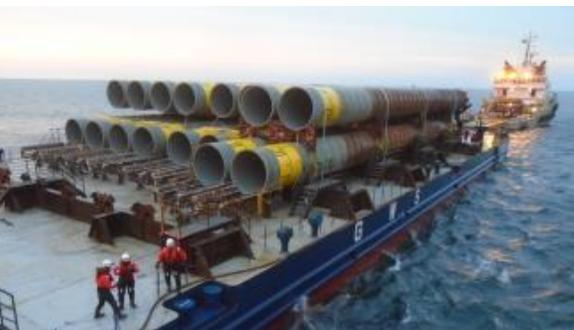
Sea Green (114 jackets sur ancrés à succion, profondeur 42 à 58m ~230 000 tonnes d'acier)
