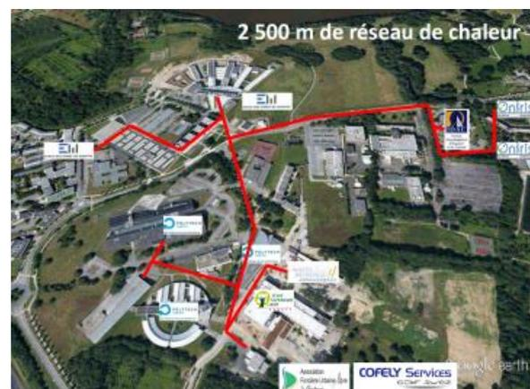
Sur le **secteur de la Presqu'île à Grenoble** un projet de réseau intéressant utilisant le réseau à très basse température, mutualisé à eau tiède (15-30°C) par géothermie vise à desservir un quartier neuf de 850000 m<sup>2</sup>. La boucle sera également alimentée par récupération de
