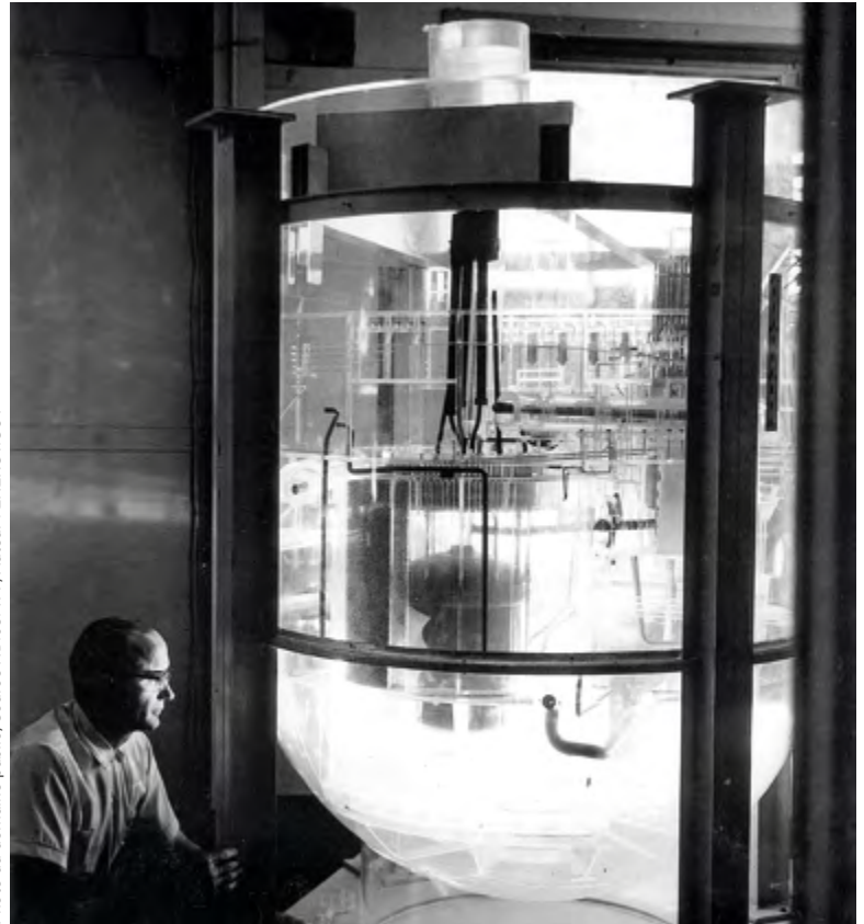
Modèle réduit (échelle 1/6) du "Molten Salt Reactor Experiment" (MSRE) d'Oakridge (USA). Le MSRE a divergé le 1 er juin 1965, et a atteint sa pleine puissance (7500 kW) en mai 1966.
