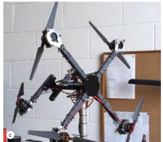
4. Photos de dispositifs expérimentaux utilisant différents types d'actionneurs mécaniques pour émuler la réponse du rotor lors d'essais en bassin. De gauche à droite : (a) câbles asservis [8], (b) turbine à air [9], (c) ensemble de propulseurs de drones aériens (figure originale de A. Otter et al. [10]).
